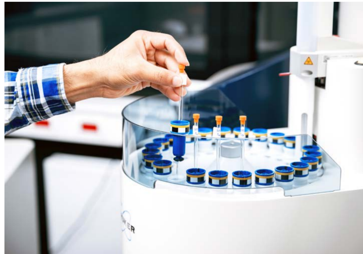
Mit dem neuen NMR-Spektroskop analysiert das Team um Thorsten Dittmar Meerwasserproben aus aller Welt. Jedes Röhrchen enthält wenige Milligramm organisches Material, das aus mehreren Litern Wasser extrahiert wurde. Mit dem Kernspinresonanzverfahren lassen sich die enthaltenen chemischen Substanzen identifizieren. Foto: Marcus Windus
