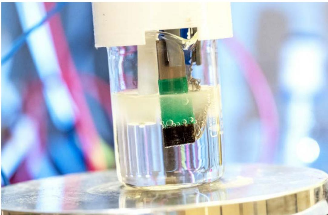
Von der Sauerstoff-Entstehung an der Anode (im Vordergrund) hängt die Geschwindigkeit der Elektrolyse ab. Die Forschenden testen verschiedene Katalysatoren – hier zu sehen als schwarze Schicht am unteren Ende der Elektrode. Foto: Daniel Schmidt
